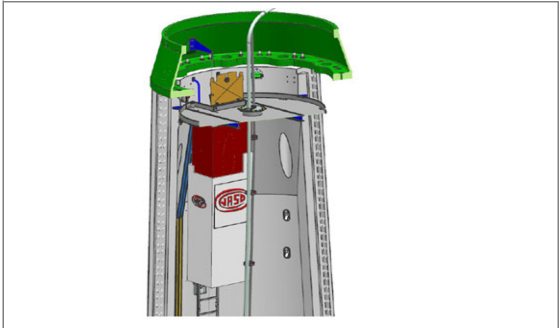
Abb. 3: JASO-Hebebühne für Betonturm (TC100N und TC168N)
